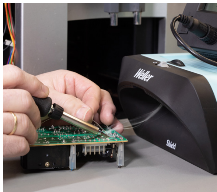
Saldatura con aspirazione dei fumi
