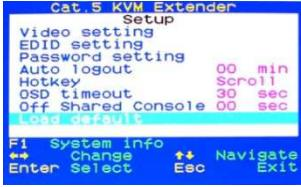
Il submenu **Video Setting** consente di regolare la luminosità, messa a fuoco e compensazione (RGB). Per prima cosa regolate la compensazione in modo da non avere contorni colorati a destra o sinistra di ogni parte bianca e nera; inoltre nell'immagine di test le linee verticali rosse e verdi dovranno essere esattamente nella stessa linea con all'interno linee verticali blu.
