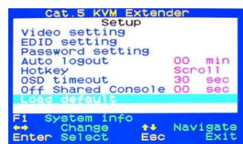
Sélectionnez ensuite **video Setting**, ce sous-menu permet le réglage de la luminosité (Brightness), du contraste (Sharpness) et la compensation (Phase red / green).
