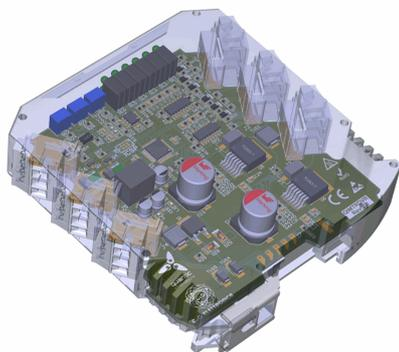
**Controllo motore CC 8-30Vdc 6-30A Modbus RS485**
